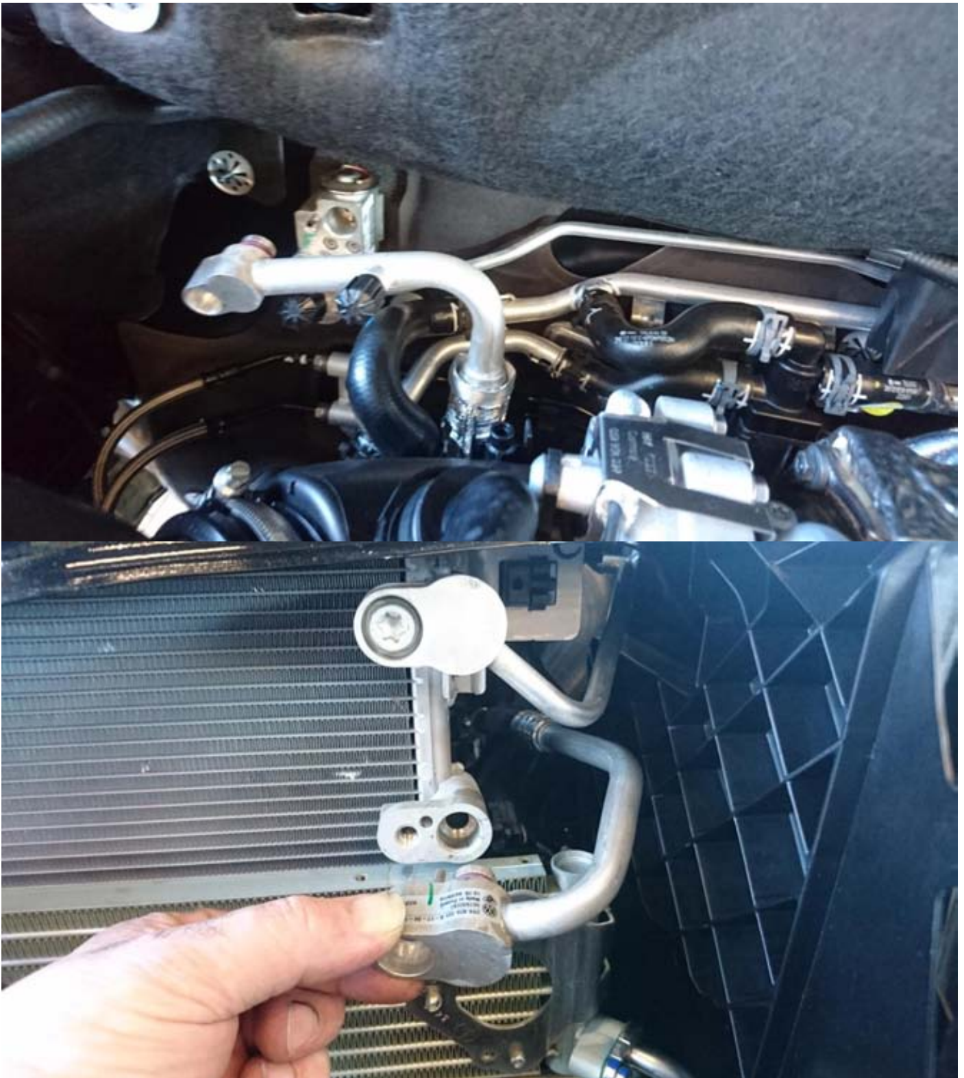
Klimaleitungen lösen / Loosen hoses Air Conditioning
