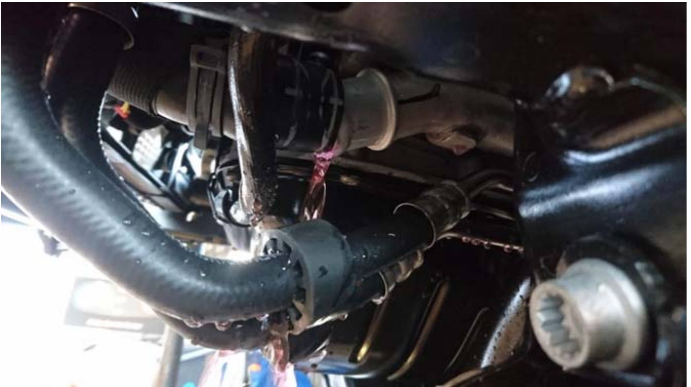
Kühler+Heizungsschläuche lösen / Loosen radiator+heating hoses
